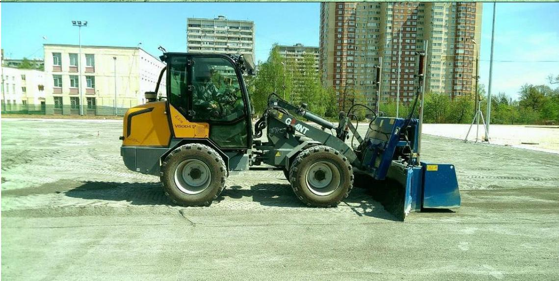
Использование лазерного планировщика в качестве грейдера (для финишного нивелирования слоев грунта)
