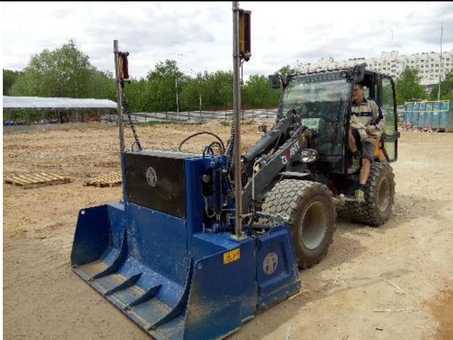
Шаг 3-й. Подключение в кабине блока управления с джойстиком к соединительным кабелям
