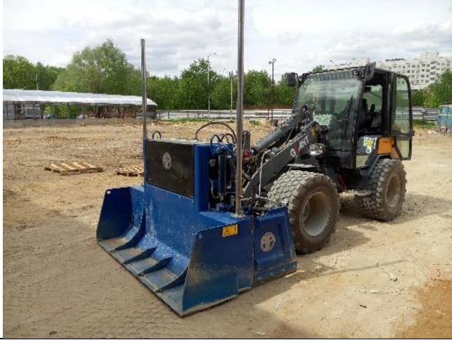
1-шаг. Подвеска рабочей насадки – сменного отвального ножа и плиты уплотнения грунта.
